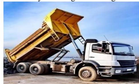
Gambar 5. *End Dump* atau *Rear Dump*
