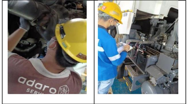
Gambar 4.6 Mengganti Steering Oil Filter dan cek battery
