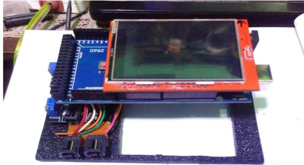
Gambar 5. Perakitan Modul Arduino untuk Sistem Pengukuran pH Dan Kekeruhan Air
